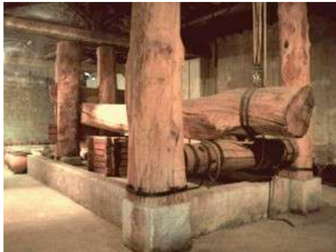
Pressoir à levier en bois reconstitué selon les indications de Caton l'Ancien (234 – 149 av JC). au Mas des Tourelles dans le Gard photo : Association Pax Augusta
