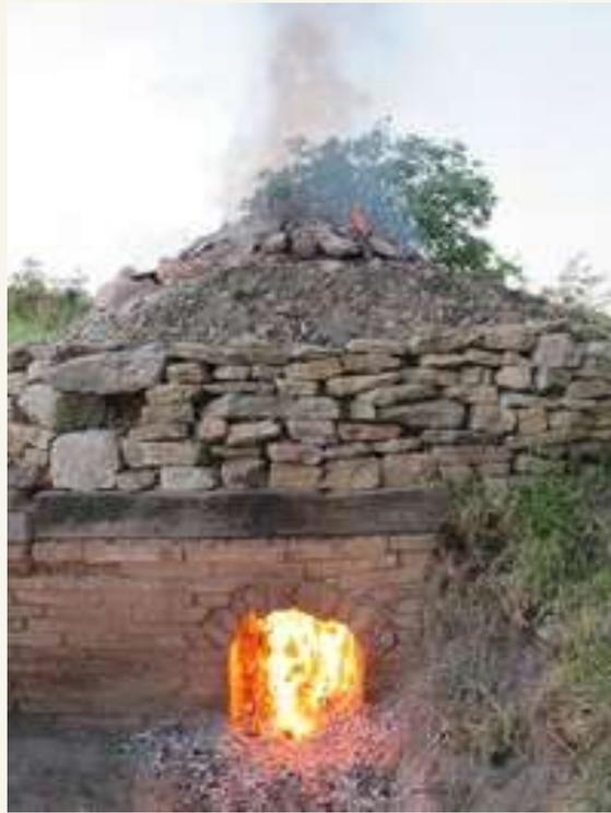
La cuisson des amphores est réalisée dans un four de grande taille : la température doit pouvoir monter progressivement jusqu'à 1000°C .
